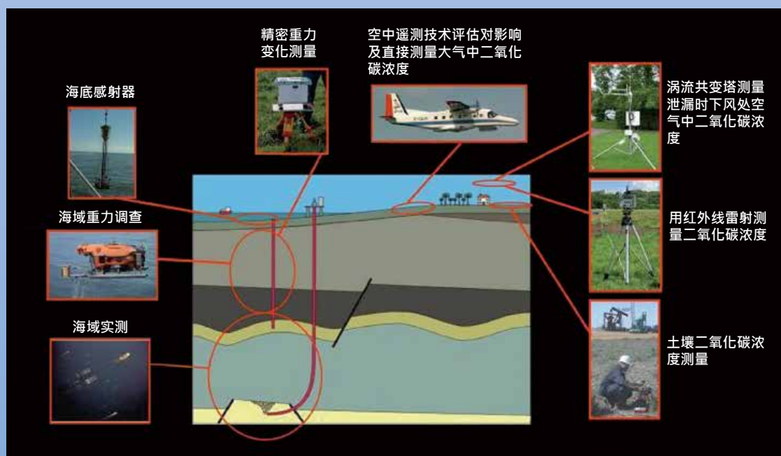
图 3 用来监测二氧化碳封存系统的技术范例，其广泛涵盖了各种区域的监测。
