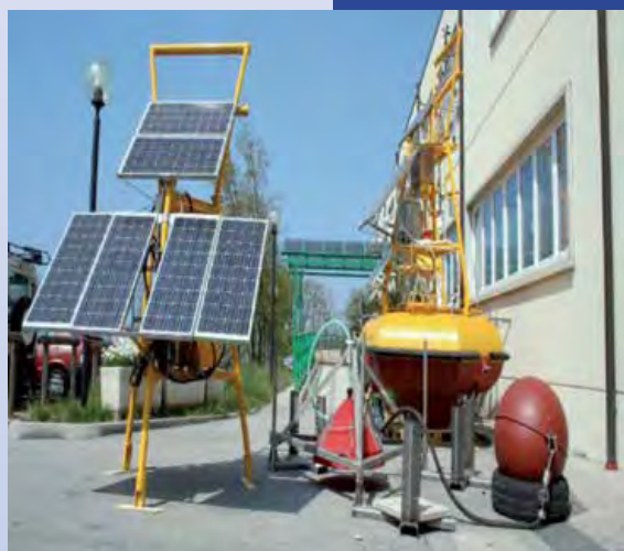
图 2 为了提供能量附设太阳能板的监测浮标，具备浮筒与取样装置，可进行海洋底部采样。
