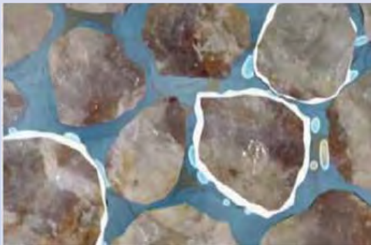
图 2 高密度的二氧化碳往上移栖(图中淡蓝色的泡泡), 溶解并与岩石的颗粒反应, 在岩石颗粒周围形成沉淀的碳酸盐矿物(白色部分)。
