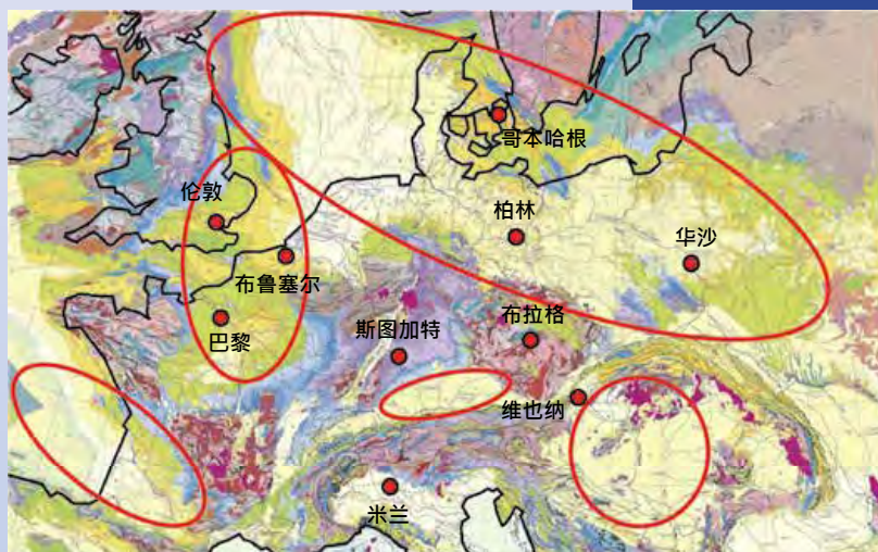
图 2 欧洲地质图 显示主要沉积盆地的分布位置 (红色椭圆部分)，在这些区域内可找到适合的二氧化碳封存场址 (参考 1:5,000,000 比例尺之欧洲地质地图)
